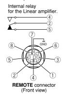
REMOTE terminal pin assignment (8-pin mini DIN)
